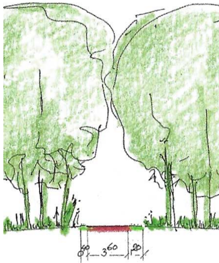
uitsnede uit het principeprofiel t.p.v. de ontsluitingsweg schaal 1:200
